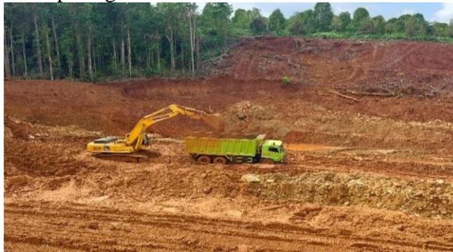
Gambar 1. Pola Pemuatan *Bottom Loading*
