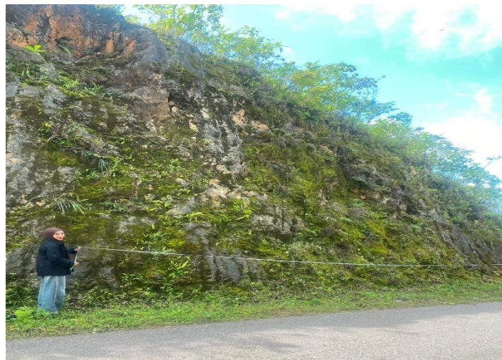
Gambar 2. Pengukuran bentangan scanline
