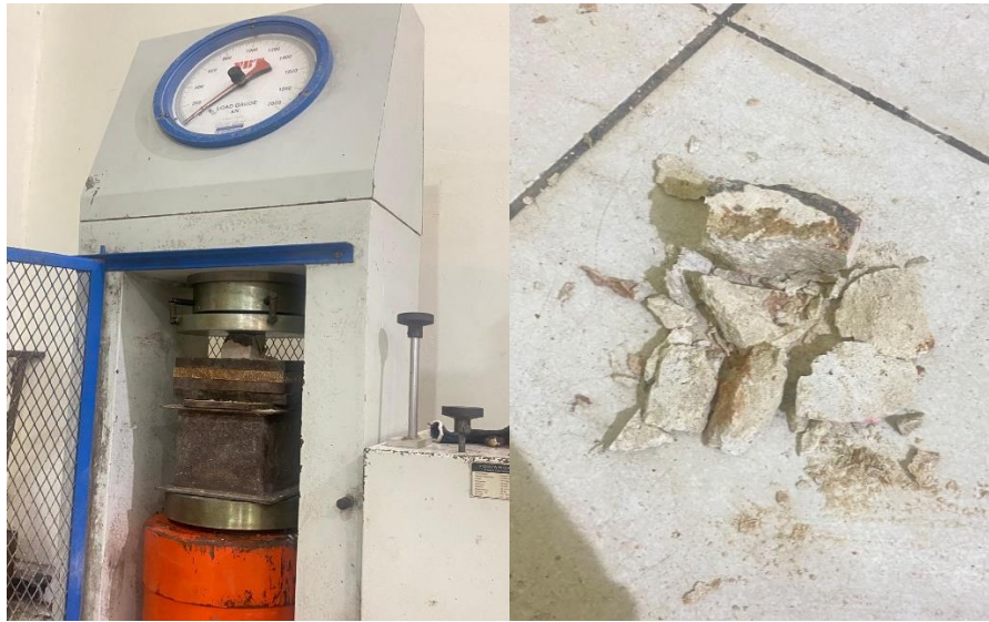
Gambar 4. Pengujian Kuat Tekan Batuan Sampel 2 (Dokumentasi LAB,2026)
