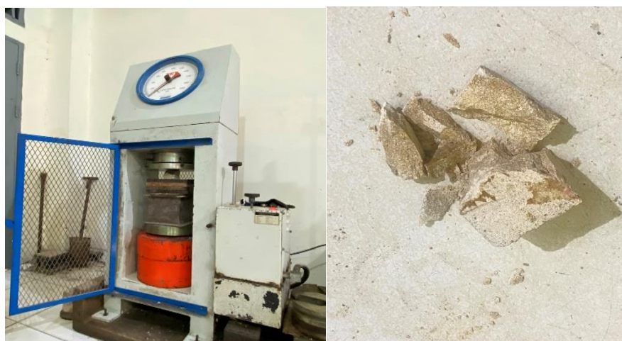
Gambar 3. Pengujian Kuat Tekan Batuan Sampel 1 (Dokumentasi LAB,2026)
