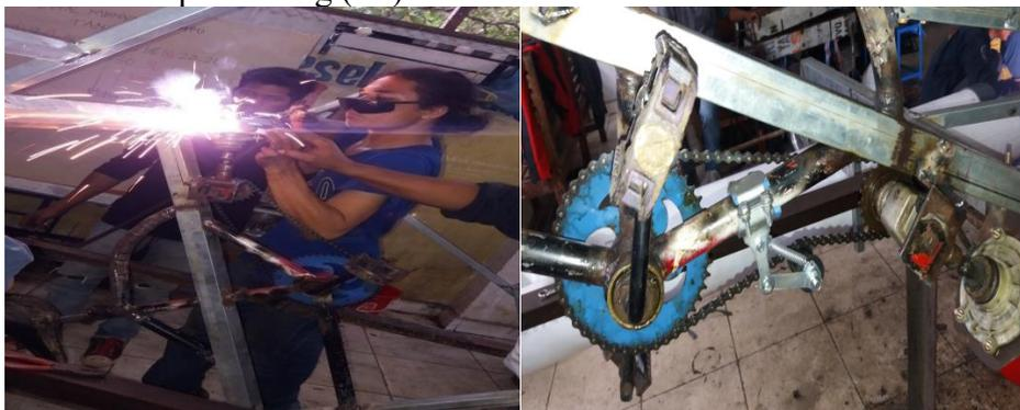
Gambar 22. Pemasangan transmisi pada sepeda air
