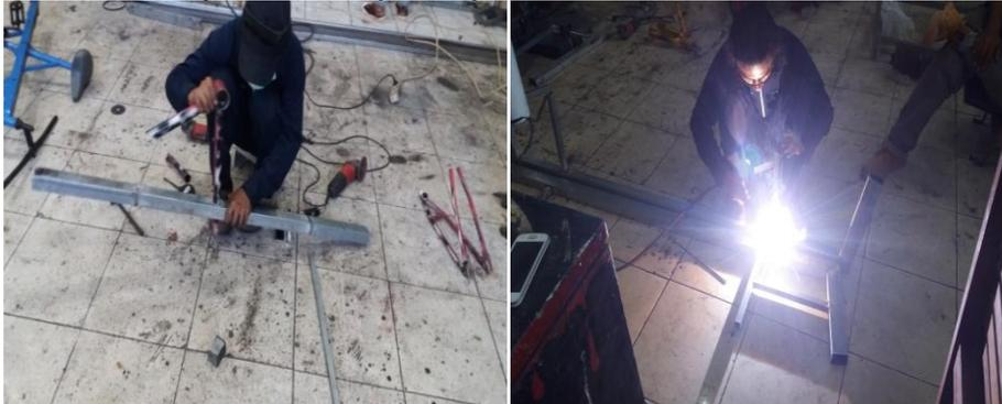
Gambar 16. Pembuatan Rangka dan proses pengelasan
